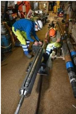
Montage von innovativer Messausrüstung zur Kontrolle und Steuerung der induzierten Mikroseismizität. © Geo-Energie Suisse
